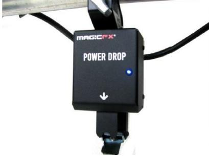
Conecte a Power Drop a uma fonte de eletricidade de 230V para verificar se todas as Power Drops foram conectadas corretamente. Quando tudo está conectado corretamente, o LED indicador azul acenderá nas Power Drops.
