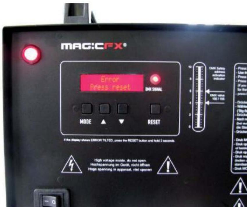
Se a Stage Flame está em conflito por mau funcionamento ou deslocamento, a tela exibirá o seguinte: 'error press reset'.
