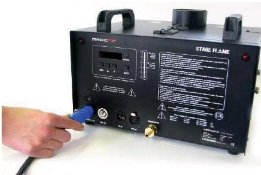
Verifique se o botão on/off está na sua posição 'desligado'. A Stage Flame opera em 230V que pode ser fornecido por meio de um cabo de alimentação IEC. A Stage Flame também é equipada com elo de ligação Powercon. Com um cabo de ligação powercon oficial, você pode ligar múltiplas Stage Flame, umas as outras.
