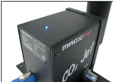
Para testar, você primeiro precisa verificar se a válvula de gás na garrafa de CO2 ainda está na posição fechada. Agora você pode verificar se o CO2 Jet foi instalada corretamente ligando e desligando a eletricidade. Se o sistema foi conectado corretamente, você ouvirá um som de clique que é produzido pela abertura e fechamento da válvula magnética na CO2 Jet.
