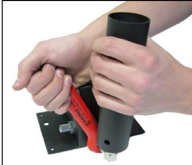
Se necessário, você pode ajustar o tubo de sopro para mudar a direção da saída.
