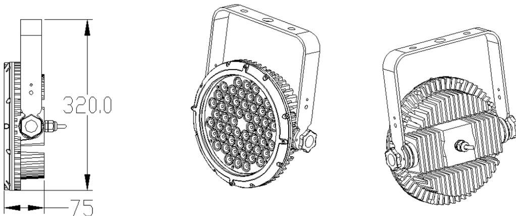
Se o iluminador precisa trabalhar na água por um longo tempo, você deve fazê-lo separado, como a foto acima. O nível a prova d'água da cabeça alcança IP68.
